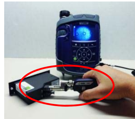
バルクヘッド側(メス側)の検査
